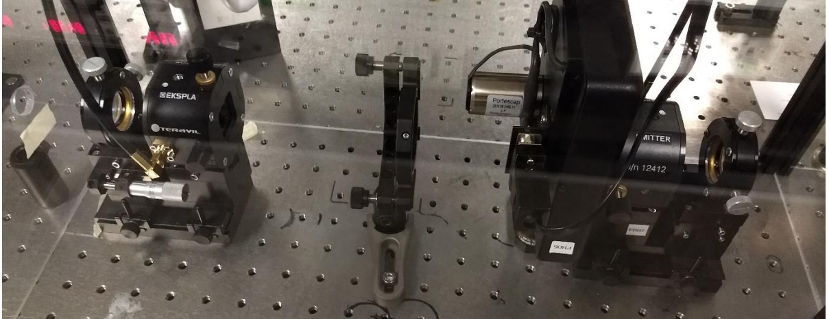
Annexe 2 – Figure 8 – Émetteur et détecteur d'ondes THz couplés chacun avec une lentille convergente (placés entre les deux se trouvent le hacheur optique et le support à échantillons)
