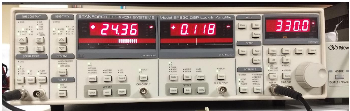
Annexe 2 – Figure 11 – Amplificateur et transformateur tension-courant
